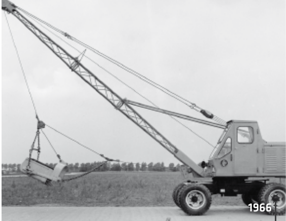
Seilbagger S833 im Schleppschaufeleinsatz
