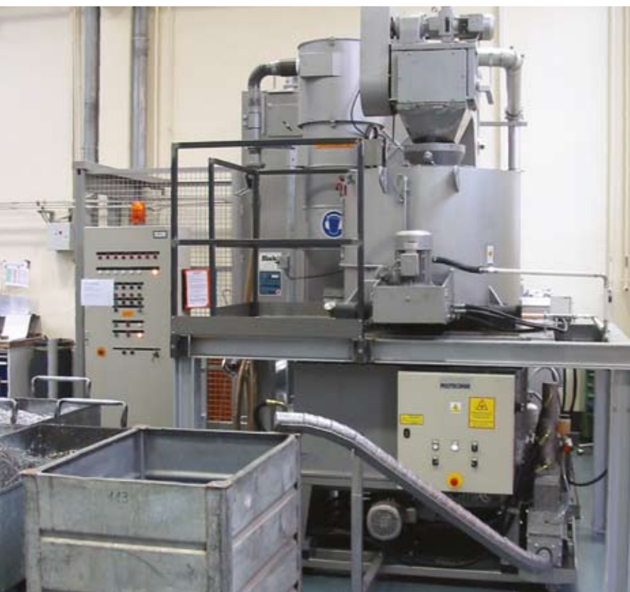
Brikstar unter einer Zentrifuge auf Schienen montiert – herausfahbar BrikStar CM on rails for moving in and out from under a centrifuge
